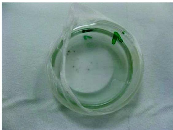
**Figure 19** : Photo du filtre en quartz contenant des particules noires à expertiser provenant de l'échantillon de plasma n°1.
