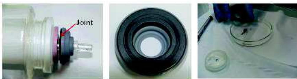
*Figure 37 : Images du joint noir et des particules récupérées suite au grattage de la surface du joint.*
