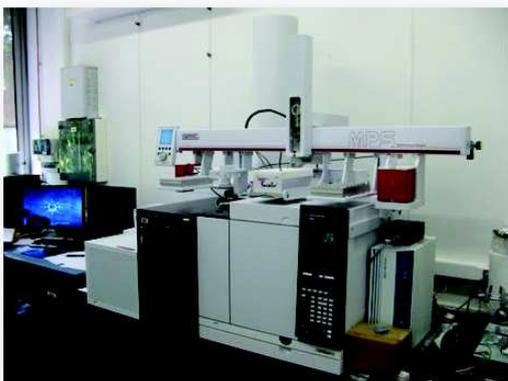
Figure 1 : GC/TOF-MS équipé du module de pyrolyse
