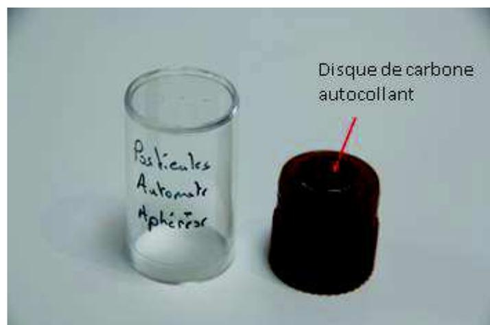
*Figure 3* : Image du « stub » sur lequel des particules provenant d'un automate pour aphérèse ont été récupérées.
